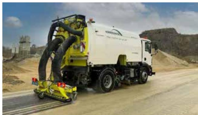
Das Hochdruck Kehrgerät reinigt asphaltierte Flächen wirkungsvoll.
